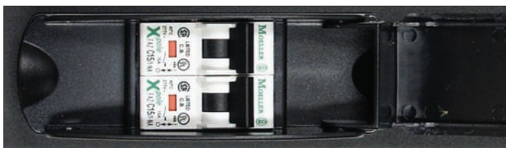
Hydrauliczno-magnetyczny bezpiecznik 30 A UL 489 na listwie zasilającej.
